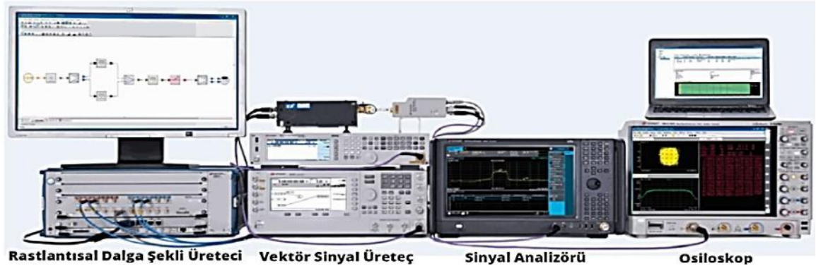
Şekil 3-15 Milimetre Dalga Komponent Karakterizasyonu Test Altyapısı
